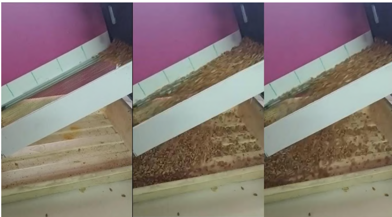
Рис. 2. Процесу просіювання зерна на пасивному струнному решеті
