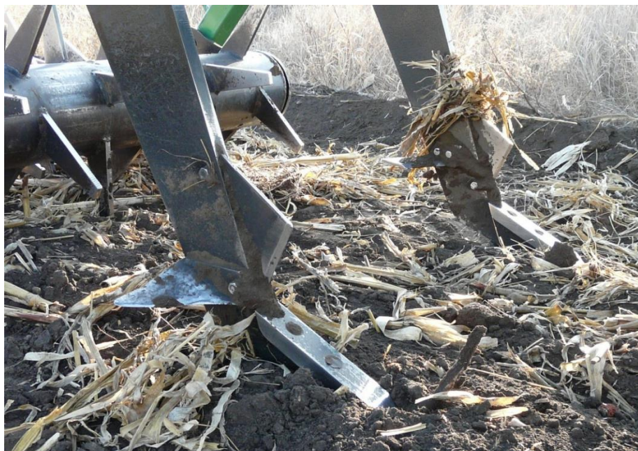
Рис. 1. Загальний робочих органів із крилами типу хвіст дельфіна
