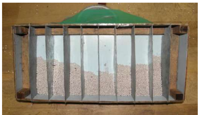
Рис. 1. Лабораторне обладнання для дослідження процесу розподілу часток по конструктивній ширині захвату робочого органа.
