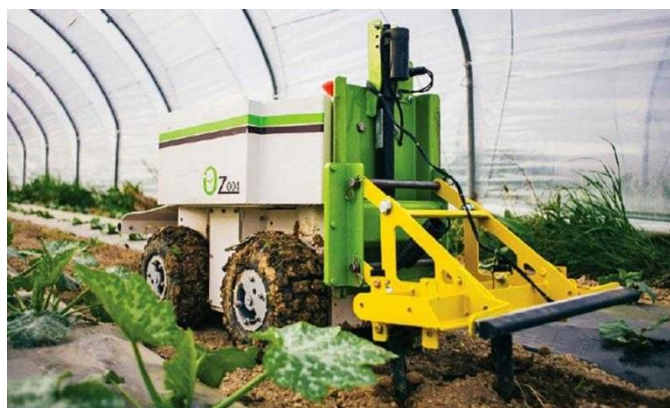
Рис. 3. Загальний вигляд робота для боротьби із бур'янами Oz
