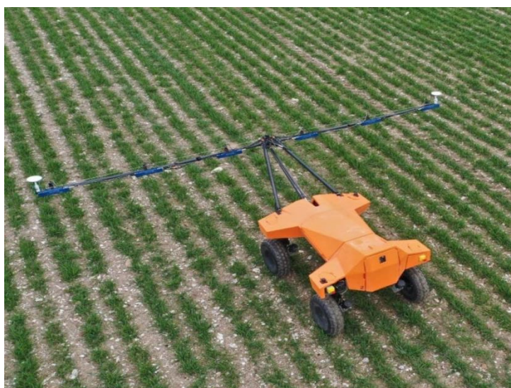
Рис. 2. Загальний вид агробота Том компанії Small Robot Company (SRC) для знищення бур'янів
