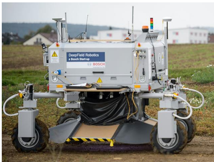
Рис. 1. Загальний вид агробота компанії Deepfield Robotics для знищення бур'янів
